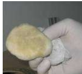
Resim 1.22: Hazırlanmış gomalak cila ve cila topu
