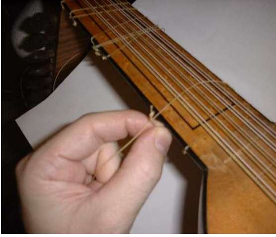
Resim 2.11: Boğum atılması
