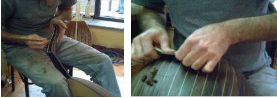
Resim 1.6: Lavtaya macun sürülmesi ve sistire yapılması
