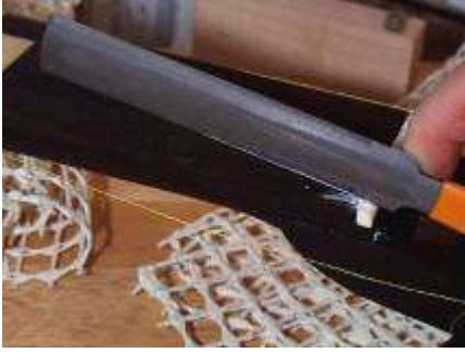
Resim 2.22: Baş eşikte tel yerlerinin belirlenmesi ve eğeyle açılması
