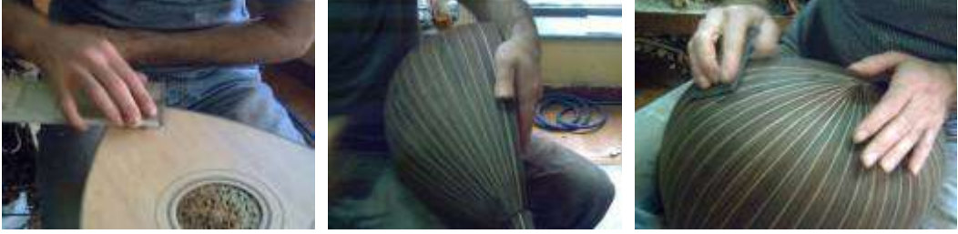
Resim 1.13: Lavtanın zımpara takozu ile zımparalanması
