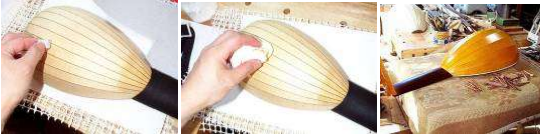
Resim 1.36: Bitirme cilası ve parlatma
