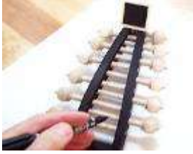
Resim 2.19: Burguların tel deliklerinin işaretlenmesi ve delinmesi
