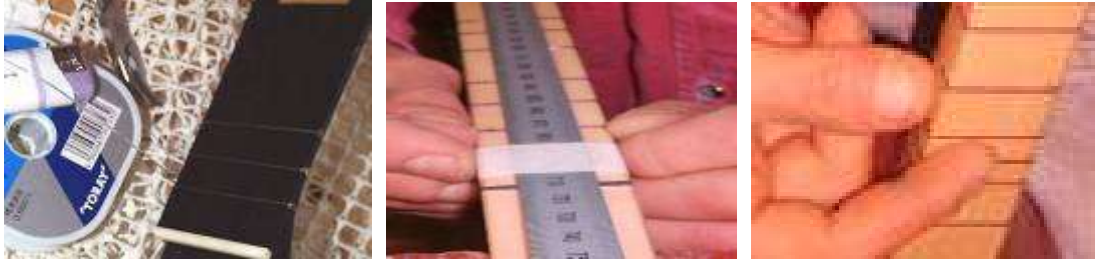
Resim 2.15: Perdelerin tamamlanması ve kaydırılarak düzeltilmesi
