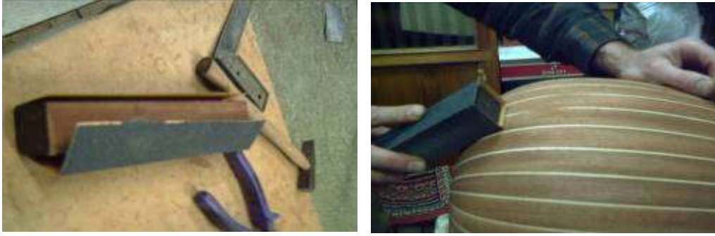
Resim 1.15: Lavtanın dolgu macunu yapıldıktan sonra daha ince zımparayla zımparalanması
