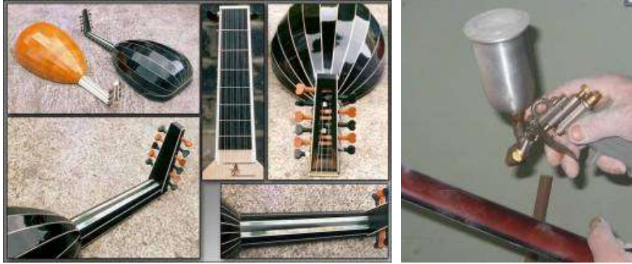
Resim 1.24: Polyester vernikli lavta ve püskürtme tabancasıyla uygulanması
