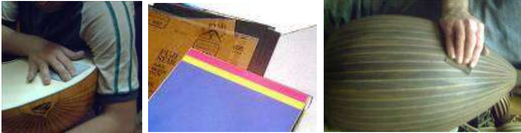
Resim 1.17: İnce zımparalama yapılması
