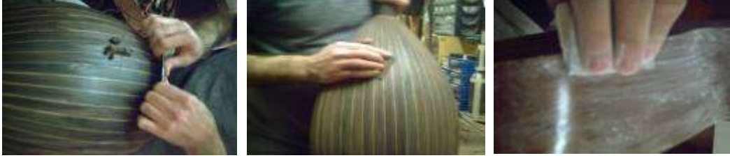
Resim 1.33: Lavtanın gomalak cilasından sonra zımparalanması ve sistirelenmesi
