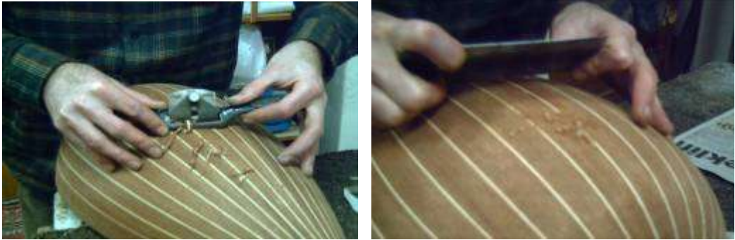
Resim 1.14: Perdah rendesi ve sistire ile yeniden kaba zımparalamanın yapılması
