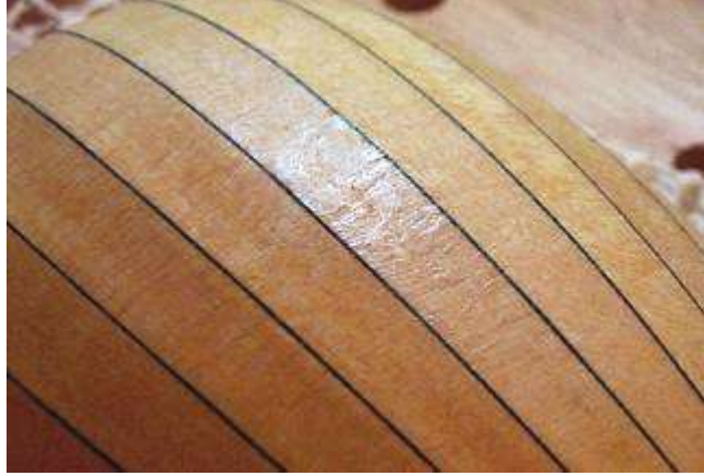
Resim 1.8: Perdahı tam yapılmamış bir lavtanın üst yüzey işleminden sonraki görünümü
