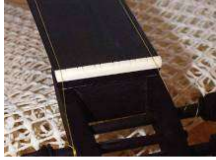
Resim 2.22: Baş eşikte tel yerlerinin belirlenmesi ve eğeyle açılması
