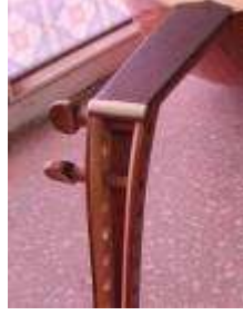
Resim 2.21: Burguların yerlerine alıştırılması
