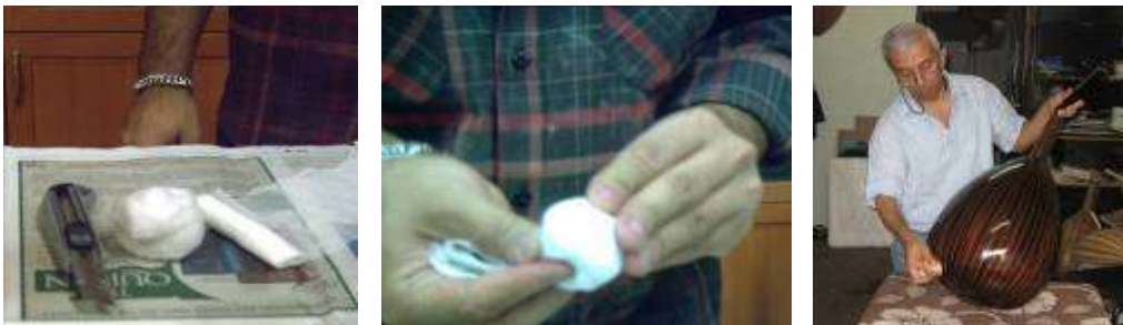
Resim 1.28: Cila topu yapımı ve uygulaması
